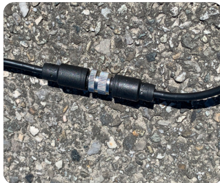
Connecteur de raccordement de la rallonge vissé à la fin de câble LVSL 60
