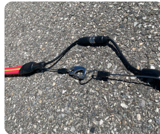
Le mousqueton du câble LVSL 60 (à gauche) est accroché à l'anneau de traction de la rallonge (à droite)
