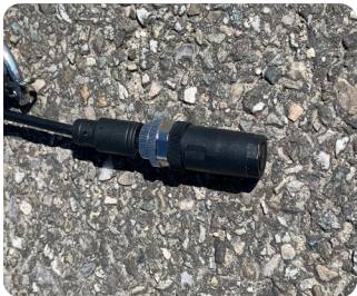
Fin de câble LVSL 60 avec embout connecteur de fin de câble à dévisser
